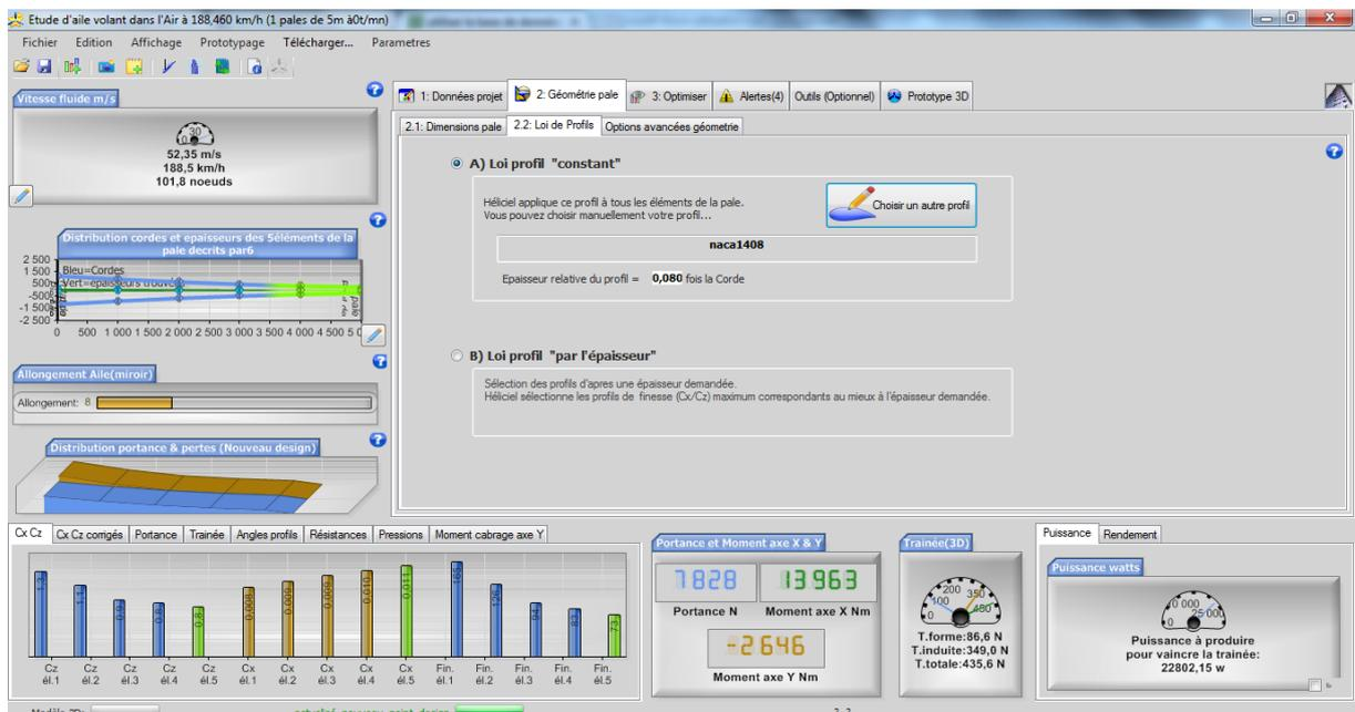
Cette étape faite nous allons pouvoir choisir le profil à modéliser, allez dans l'inter active data base profils ou cliquez simplement sur : Choisir un autre profil. Il s'affiche alors la base de données d'helicel composée de très nombreux profils différents, si les profils présents ne vous suffisent pas vous pouvez en télécharger d'autres.
